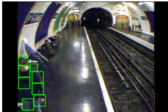
Séquence quai métro : carré vert = détection de mouvement ; jaune = position dangereuse ; rouge = position interdite.
