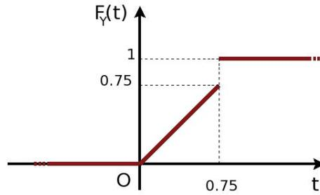
FIGURE 3.7 – exemple de la machine à remplir les bouteilles : graphe de la fonction de répartition de la loi de  $Y$ .
