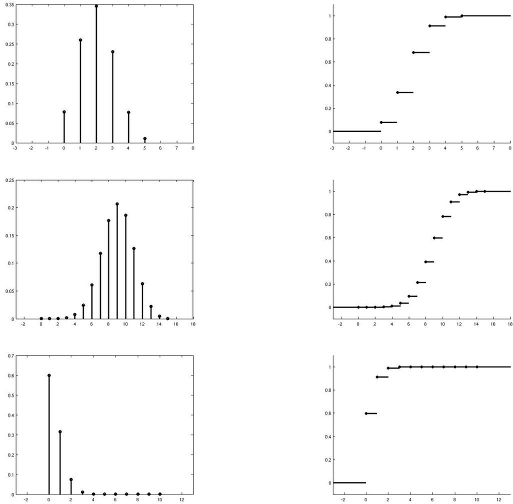
FIGURE 3.3 – lois binomiales (à gauche) et fonctions de répartition  $F_X$  correspondantes (à droite) pour différents paramètres : 1e ligne :  $n = 5, p = 0.4$ ; 2e ligne :  $n = 15, p = 0.6$ ; 3e ligne :  $n = 10, p = 0.05$ .
