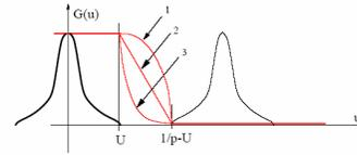
FIG. 3.3 – Trois filtres possibles pour reconstruire exactement un signal suréchantillonné (les filtres sont symétriques pour les  $u$  négatifs). Ils diffèrent par leurs valeurs dans l'intervalle compris entre  $U$  et  $1/p - U$ .
