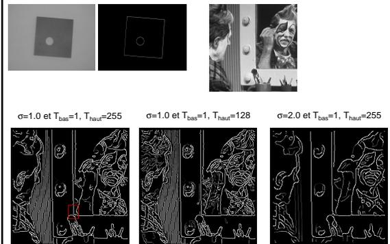
$\sigma=1.0$  et  $T_{bas}=1, T_{haut}=255$      $\sigma=1.0$  et  $T_{bas}=1, T_{haut}=128$      $\sigma=2.0$  et  $T_{bas}=1, T_{haut}=255$
