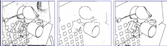
Passage par zéro du laplacien avec seuillage du module du gradient ( $s=1$ )
