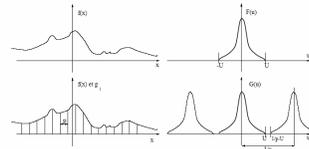
FIG. 3.1 - Échantillonnage d'un signal continu  $f(x)$ , à spectre  $F(u)$  à support borné, avec un pas d'échantillonnage  $p$ . Le signal résultant discret a un spectre  $[F(u)]^2$ .
