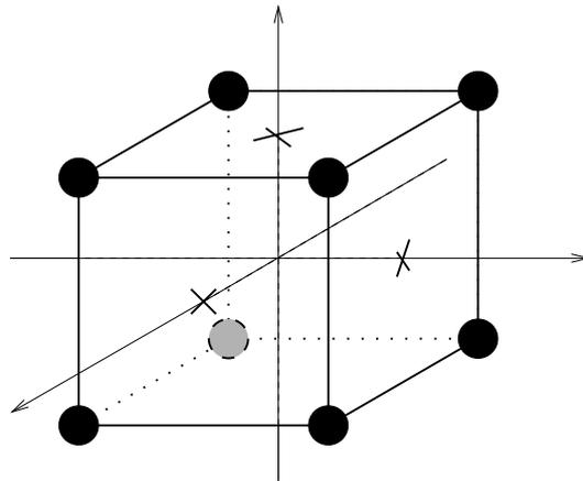
FIG. 1 – Constellation d'une modulation OFDM à 3 porteuses.
