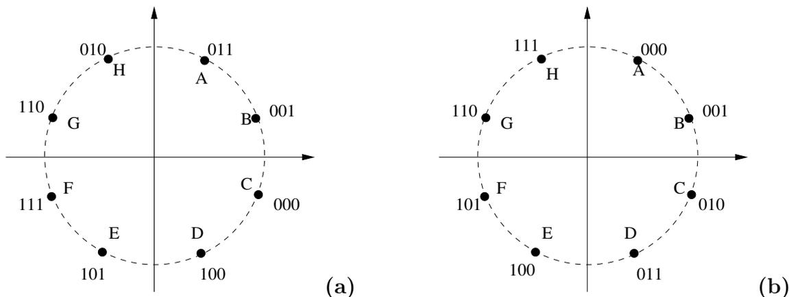
FIGURE 3 – Constellation d'une modulation de phase à 8 états, avec deux associations possibles mot binaire - symbole.
