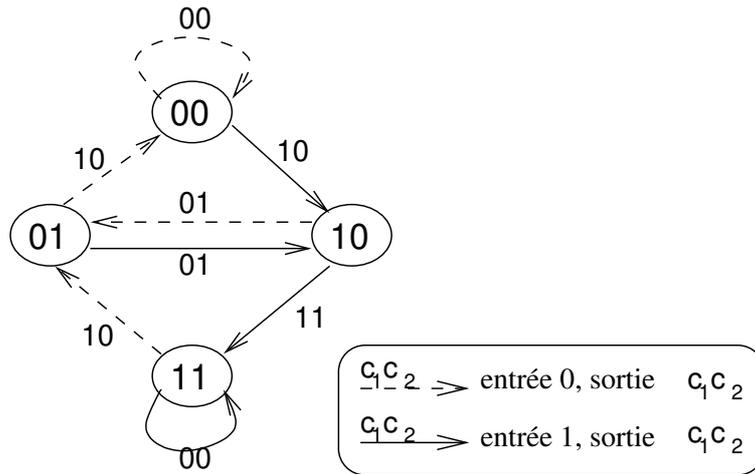
FIGURE 2 – Diagramme d'états d'un codeur convolutif  $\mathcal{C}(2, 1, 3)$  (entrée 1 bit, sortie 2 bits).
