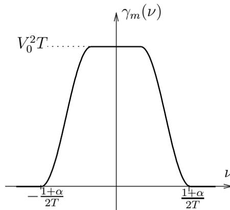
FIGURE 5 – Densité spectrale de puissance d'un signal modulant NRZ, pour des impulsions de base en cosinus surélevé avec un facteur de retombée  $\alpha$
