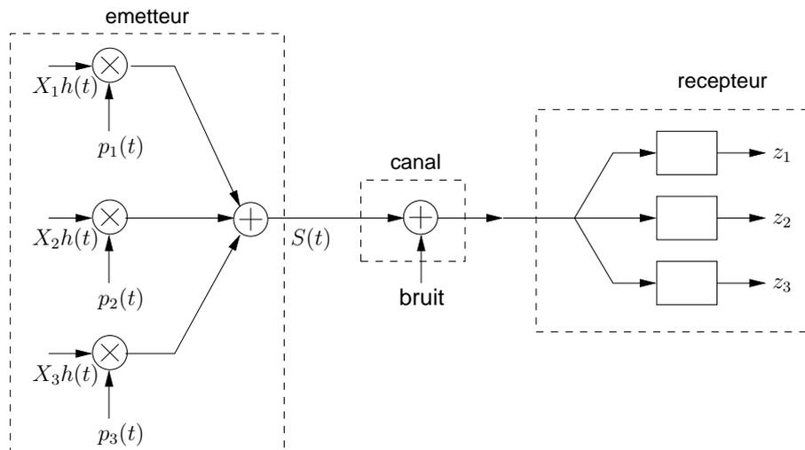
FIGURE 4 – Schéma de transmission OFDM à 3 porteuses.
