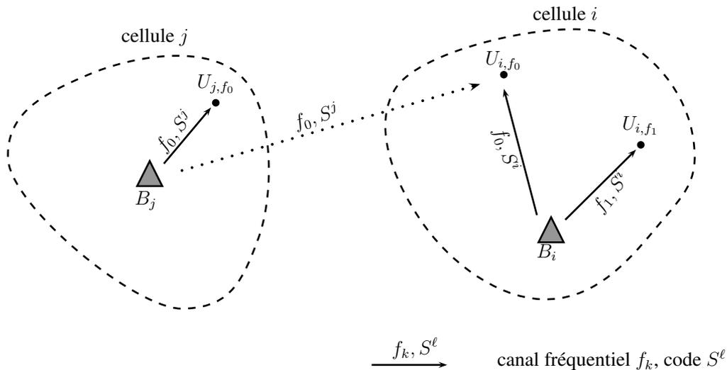
FIGURE 3 – Cellules et canaux.
