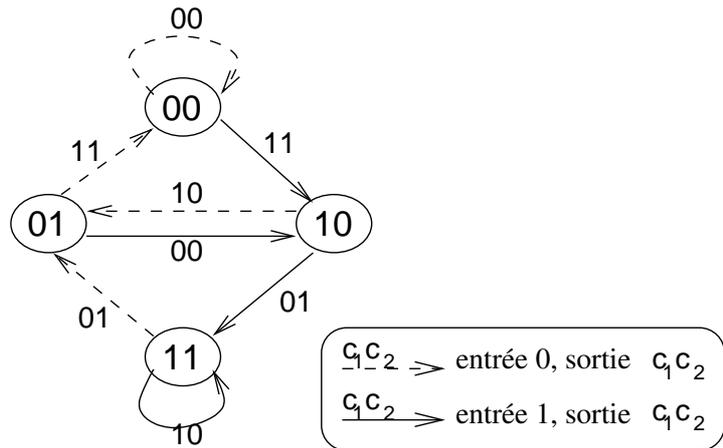
FIGURE 2 – Diagramme d'état du codeur  $\mathcal{C}(2, 1, 3)$ .
