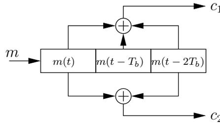
FIGURE 1 – Circuit d'un codeur convolutif  $\mathcal{C}(2, 1, 3)$ .
