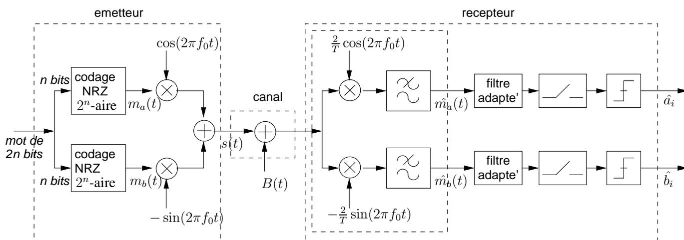
FIG. 1 – Chaîne de communication pour une MAQ.
