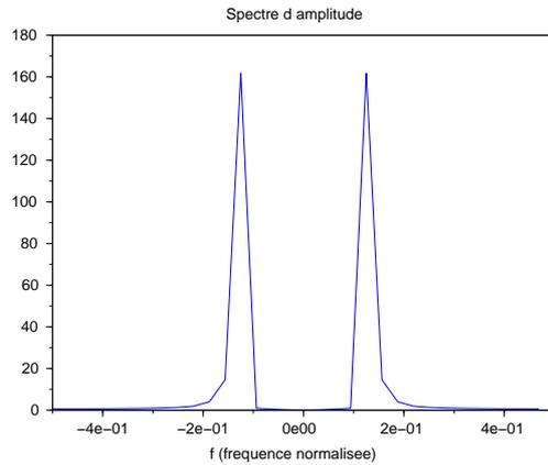
FIGURE 7 – Spectre d’amplitude pour un fenêtrage rectangulaire sur 32 échantillons.
