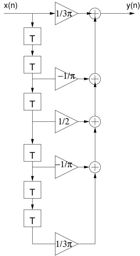
transition de 1/11. Si l'on met en cascade 2 filtres comme celui-ci, la bande de transition reste la même et l'atténuation en dB est doublée, passant à -42. On respecte donc bien le gabarit initial. Intérêt : structure moins sensible aux erreurs de quantification des échantillons et des coefficients.
