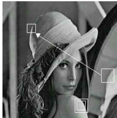
Figure 70 : Exemples de transformations permettant de retrouver un range bloc à partir d'un domaine bloc plus grand dans l'image Lena.
