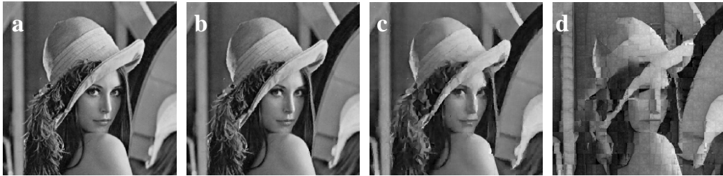
Figure 71 : Image « Lena » (a) et images obtenues via une compression fractale pour laquelle les tailles des domaines blocs carrés ont été fixées à 4 pixels (b), 8 pixels (c) et 16 pixels (d)
