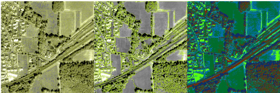
FIGURE 3.17 – Segmentation d'images, de gauche à droite, par Ligne de Partage des Eaux, Mean Shift (segments entourés) et seuillage multiple par la méthode d'Otsu (une couleur par segment).
