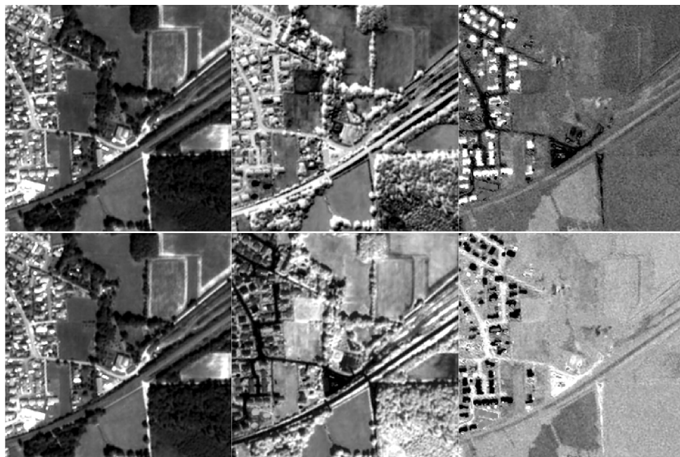
FIGURE 4.1 – Résultats d'une ACP (en haut) et de sa variante à bruit ajusté réalisée sur une image Pléiades (RVB-IR) de la Figure 3.2 : les trois premières composantes de l'ACP correspondant aux valeurs propres (par ordre décroissant de gauche à droite).
