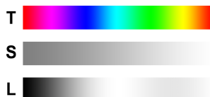
FIGURE 3.3 – Espace colorimétrique TSL (Teinte Saturation Lumière).
