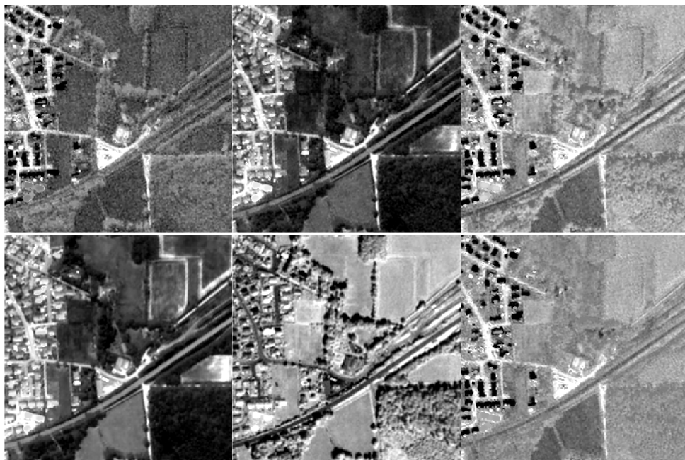
FIGURE 4.2 – ICA (en haut) et MAF (en bas) réalisées sur une image Pléiades (RVB-IR) de la Figure 3.2 : les composantes de l’ACP correspondant aux valeurs propres (par ordre décroissant de gauche à droite).
