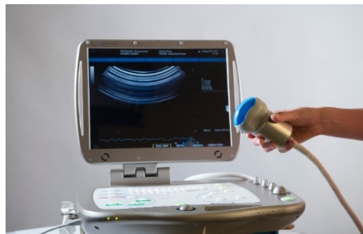
Figure 1 - Echo, l'échographe téléopéré à bord de l'ISS.
