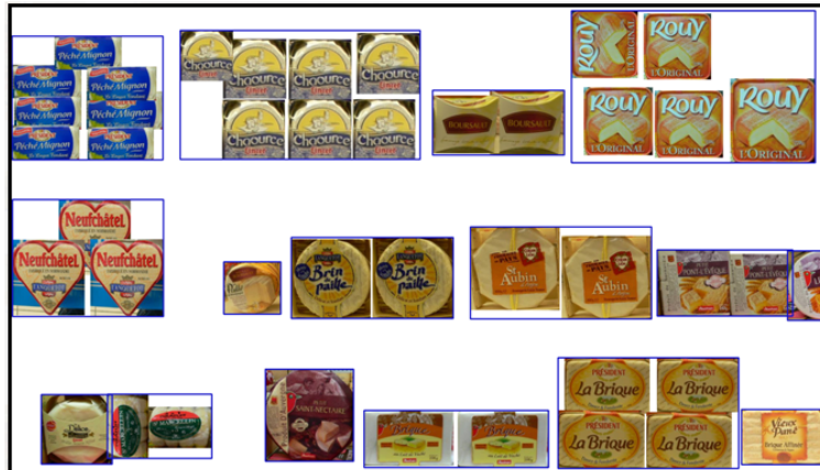
FIGURE 1.3 – Exemple de résultat d’une analyse d’une photo de linéaire. Les images de la base de produits détectés sur la photo à analyser sont copiés à l’emplacement où ils sont trouvés. Sur cette image, on a aussi tracé un rectangle autour des zones de même produit.
