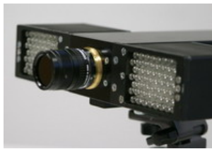
FIGURE 8.2 – Exemple de caméra TOF. Modèle de la société PMD Technologies GmbH.
